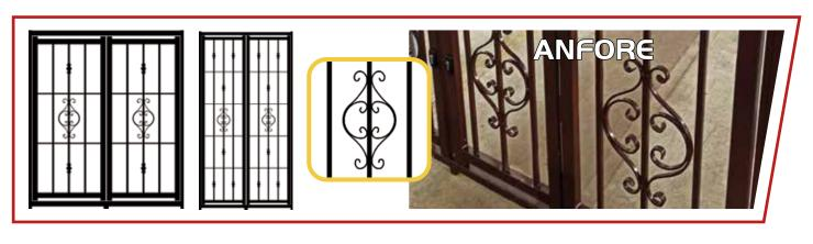
Realizzate con telaio ed **anta tubolare** in acciaio zincato **40x30** da 20/10. Specchiature realizzate in **acciaio zincato pieno**, tondo da diam. 16 infilato in barra forgiata asolata da **16 mm.** decori ornamentali zincati a seconda della tipologia.
